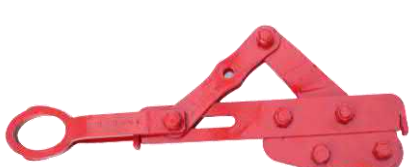
Serre broche (tendeur) Capacité 1 000 lb ou 1 500 lb #9 et #12 avec ressort de rappel (Généralement utilisé en paire)
